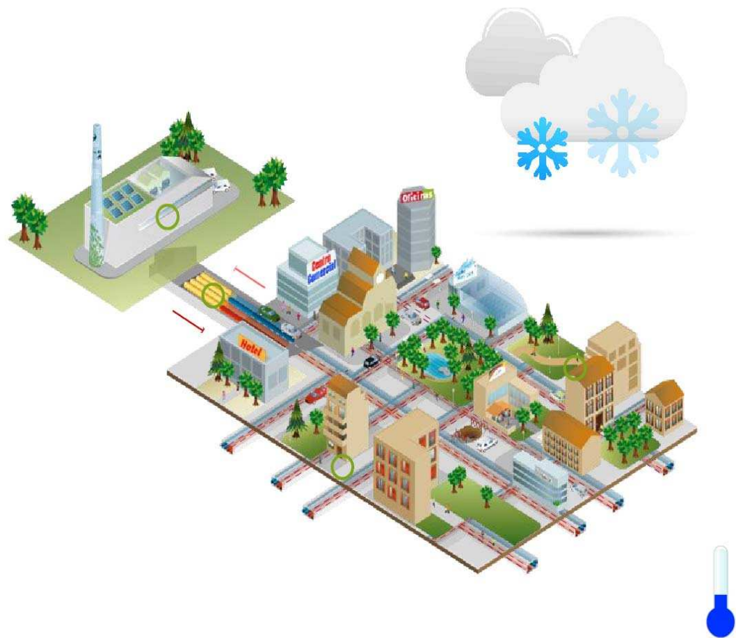
Figura 3. Esquema de la red de distrito en el que se muestran los elementos principales (central, red y consumidores)
